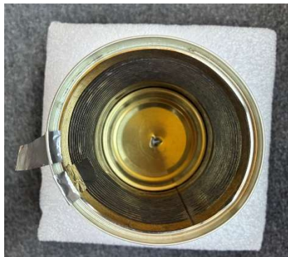
Obr. 2. Pohled na nabitou plechovku se zvednutým lístečkem na vnější straně a nezvednutým na vnitřní straně plechovky.
