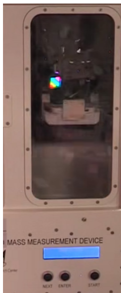
Obr. 6. Mass measurement device na ISS – v podstatě váhy, fungující na principu 2. N. z.
