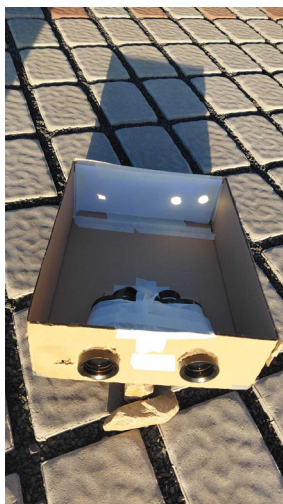
Obr. 2. Hotová krabice v akci. Vpředu otvory pro objektivy, vzadu stínítko.
